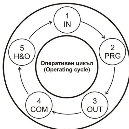
Фиг.1.7. Основни действия на PLC.
