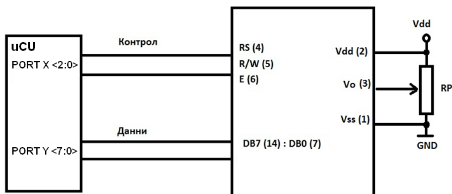
Фиг. 9.2. Свързване на микроконтролер с LCD дисплей по 8-битов интерфейс
