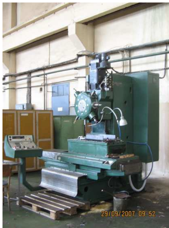
Фиг. 4.11 Общ вид на пробивна машина с револверна глава PB002.20 (1 – тяло; 2 – защита на напречните направляващи; 3 – защита на надлъжните направляващи; 4 – маса; 5 – револверна глава; 6 – вретена; 7 – главен електродвигател; 8 – супорт; 9 – стойка; 10 – пулт за ръчно управление)
