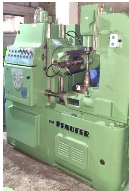
Фиг. 9.8 Общ вид на зъбофрезова машина, работеща по метода Пфаутер, модел 532 (а) и P2B1 (б) (1 – тяло; 2 – главен електродвигател; 3 – стойка; 4 – кръгова скала; 5 – супорт; 6 – електродвигател за бърз ход; 7 – гредя; 8 – опора 9 – дорник за заготовката; 10 – задна стойка; 11 – маса )
