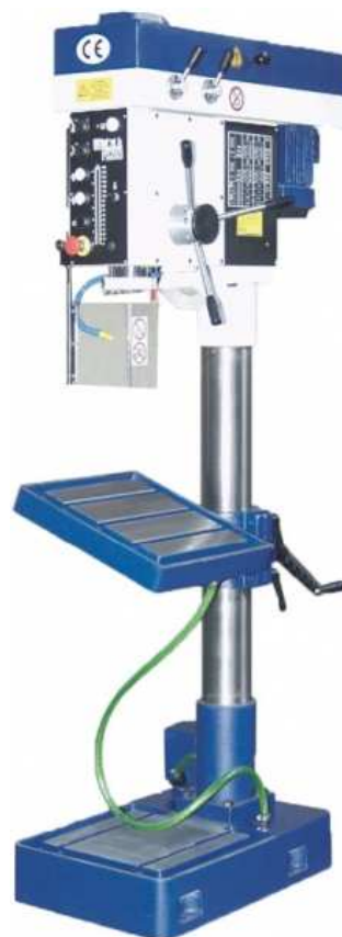
Фиг. 4.4 Общ вид на едновретенна колонна пробивна машина ПК203 (1 – основа; 2 – маса; 3 – стиска; 4 – обработвана заготовка; 5 – вретено с инструмент; 6 – ръчка за подавателния превод; 7 – главен превод; 8 – ръчки за превключване на честотите на въртене; 9 – електродвигател; 10 – колело за ръчно осово подаване; 11 – шлаух за подаване на МОТ; 12 – колона; 13 – помпа за подаване на МОТ)
