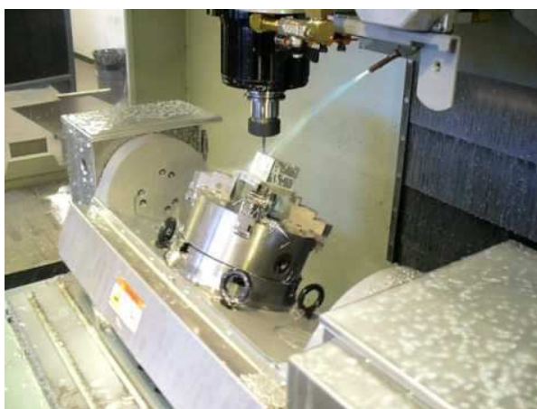
Фиг. 5.32 Фрезова машина с ЦПУ с 5 CNC-управляеми оси и една люлка с две кръгови оси (А и С) за детайла
