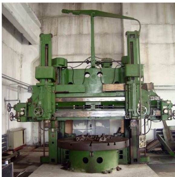
Фиг. 3.43 Двустойков вертикален струг (1 – тяло; 2 – планшайба; 3 – пулт за управление; 4 – стойки; 5 – неподвижна гредка; 6 – подвижна гредка; 7,8 – хоризонтални супорти; 9 – вертикален супорт; 10 – револверна глава )
