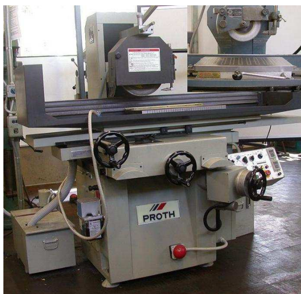
Фиг. 8.10 Общ вид на машина за шлифование на равнинни повърхнини (1 – тяло; 2 – маса; 3 – магнитна (електромагнитна) маса; 4 – шлифовъчен диск; 5 – колона; 6 – вертикална шейна; 7 – дюза за подаване на СОТ; 8 – напречна шейна; 9 – система за подаване на СОТ; 10 – пулт за управление; 11 – ограничители)
