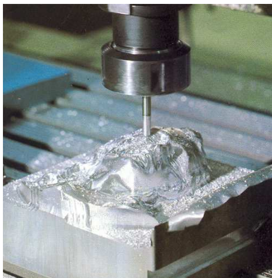
Фиг.5.28 Обработване на обемна профилна повърхнина върху фрезова машина с ЦПУ (МАНО МН-С700NC)
