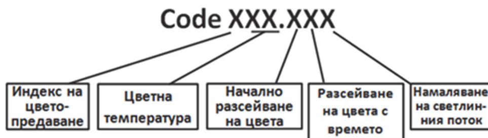
Фиг. 15.10. Шестцифрен фотометричен код за обозначаване на параметрите на LED
