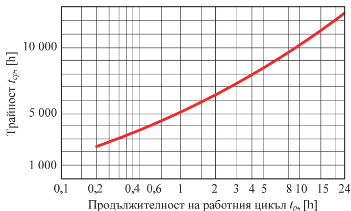
Фиг. 10.7. Зависимост на трайността на ЛЛ от продължителността на работния цикъл
