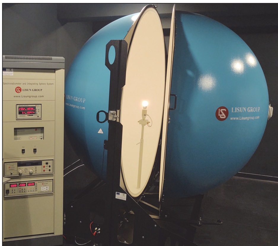
Фиг. 3.1. Интегриращ кълбов фотометър (сфера на Улбрихт) за измерване на светлинен поток
