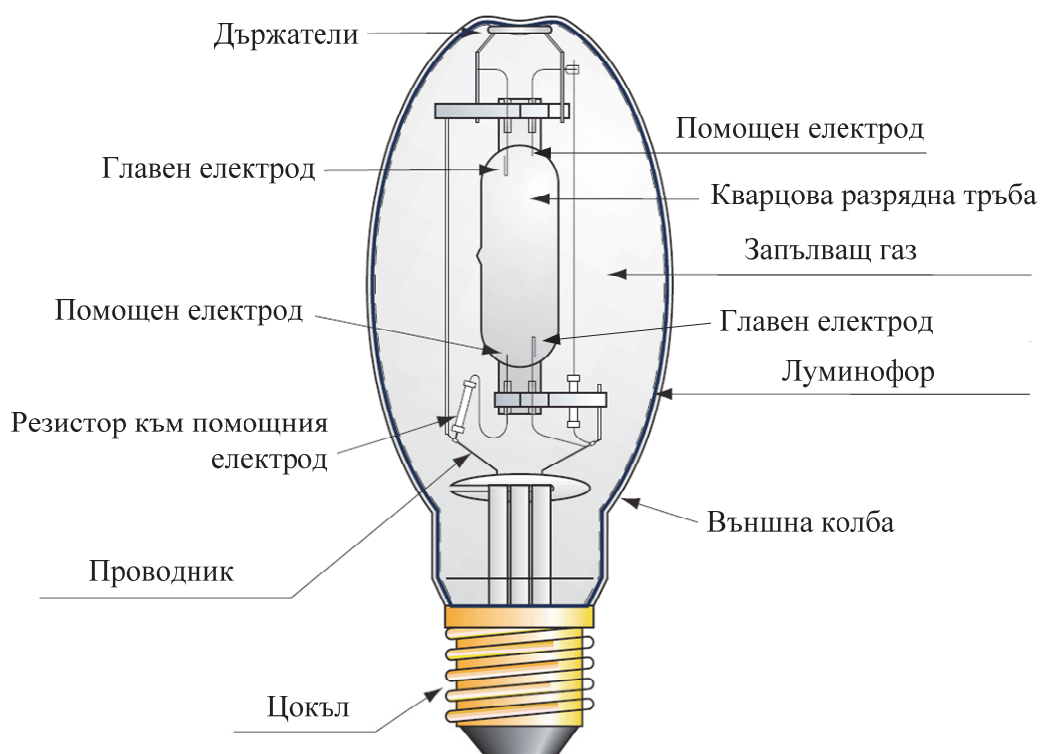
Фиг. 11.1. Устройство на живачна лампа с високо налягане
