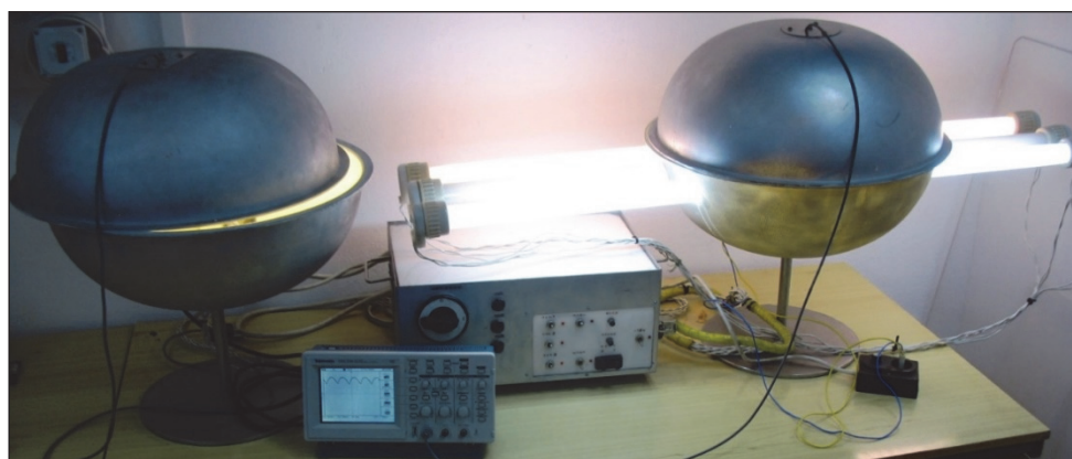
Фиг. 19.10. Лабораторна постановка за измерване на пулсации на светлинния поток
